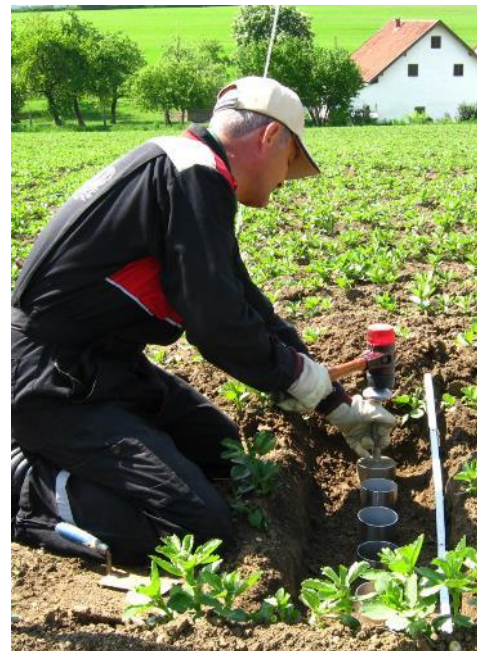
Abbildung 10: Einschlagen der Stechzylinder mit dem Hammer
