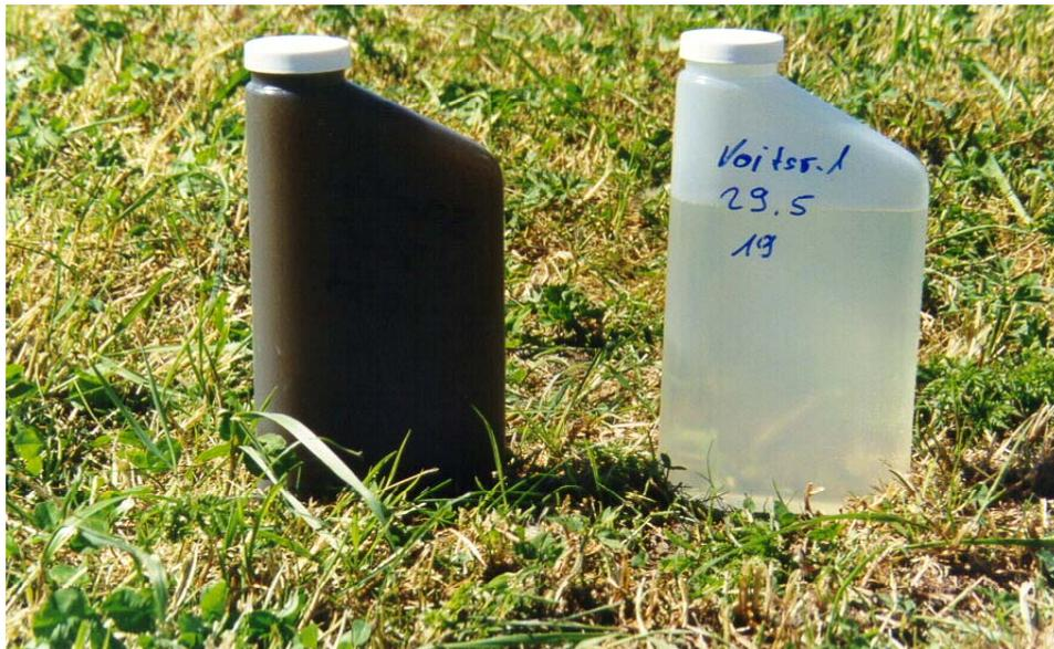
Abb. 38: Wasserproben aus Drainagen nach einem simulierten Starkregenereignis (links nach vorausgegangener Gülleapplikation, rechts nach Beregnung ohne vorheriger Gülleausbringung)
