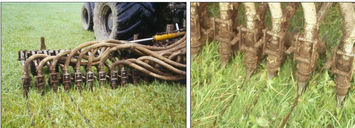
Abb. 8: Gülleausbringung mit flacher Injektion (Schlitztechnik)
