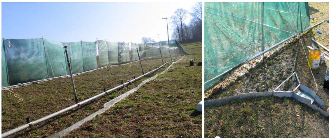
Abb. 11: Beregnungsanlage mit Windschutz und Leitblechen (links)
