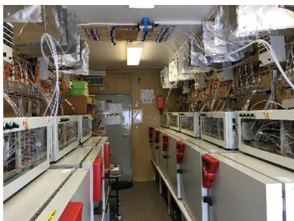
Abb. 4: Emissionsmessanlage zur Erfassung der Ammoniakfreisetzung während der Lagerung.
