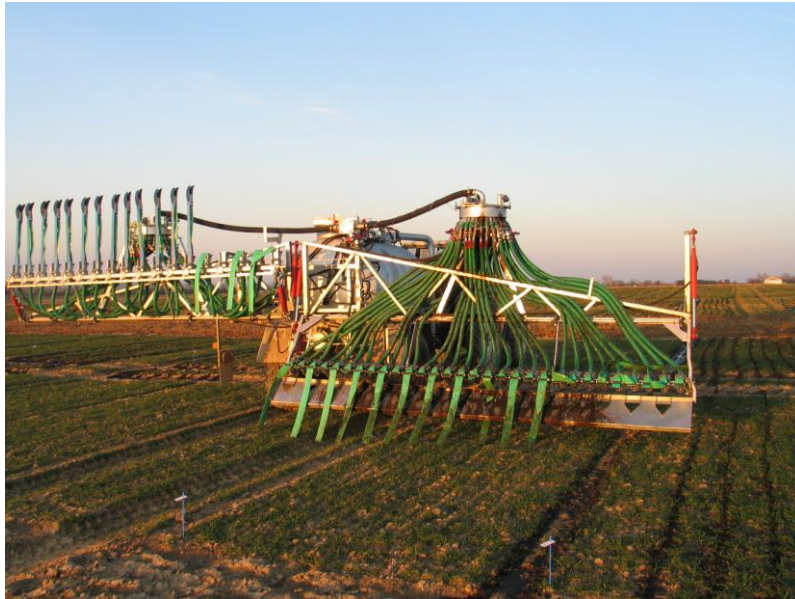
Abbildung 1: Versuchsfass zur präzisen Ausbringung der Biogasgärreste in den Versuchen der Bayerischen Landesanstalt für Landwirtschaft. Am linken Ausleger sind Schleppschuhe (aufgeklappt), am rechten Schleppschläuche sowie ein Leitblech zur breitflächigen Applikation (abgeklappt) angebracht
