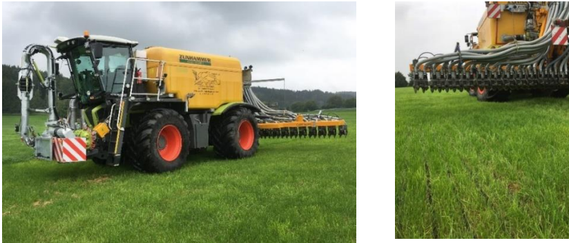
Abbildung 4: Injektionstechnik (hier Selbstfahrer) – Gerät und Ergebnis im Bestand (Bilder: LfL)
