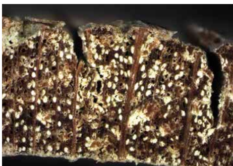
Querschnitt Buchenschäl furnier mit zementgefüllten Gefäßen (links) und REM-Aufnahme einer Gefäßwand mit anhaftendem Zementstein im Längsschnitt (rechts). Fotos: TH Rosenheim
