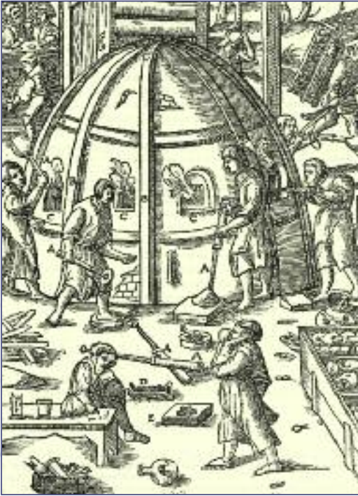
Darstellung eines Glasofens und des Glashüttenbetriebes im Bergbaubuch des Georg Agricola aus dem 16. Jahrhundert. Herz einer Glashütte war der Schmelzofen, der aus handgefertigten Ton-Schamotte-Ziegeln gemauert war.
