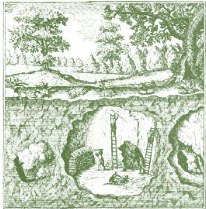
Um das Gestein in den Gruben aufzubrechen wurde Feuer gesetzt. Dadurch entstanden Spannungen im Gesteinsinneren, die es zum Bersten brachten, wie hier im Bergbauspiegel von 1700 dargestellt.
