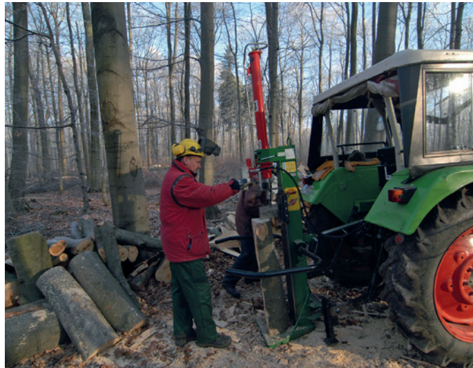
3 Hydraulische Holzspalter gehören auch in vielen Kleinbetrieben zur Grundausrüstung. Christian Mühlhausen, landpixel.de
