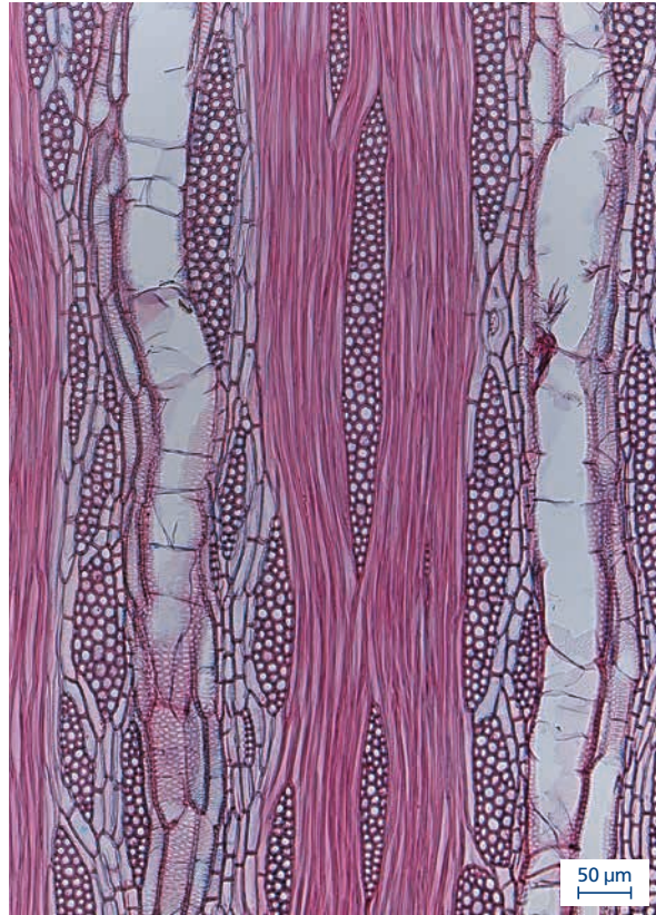
Abbildung 5 (oben links): Mikrofoto des Querschnitts der Robinie. Die Vergrößerung zeigt die intensive Verthyllung der Gefäße.
