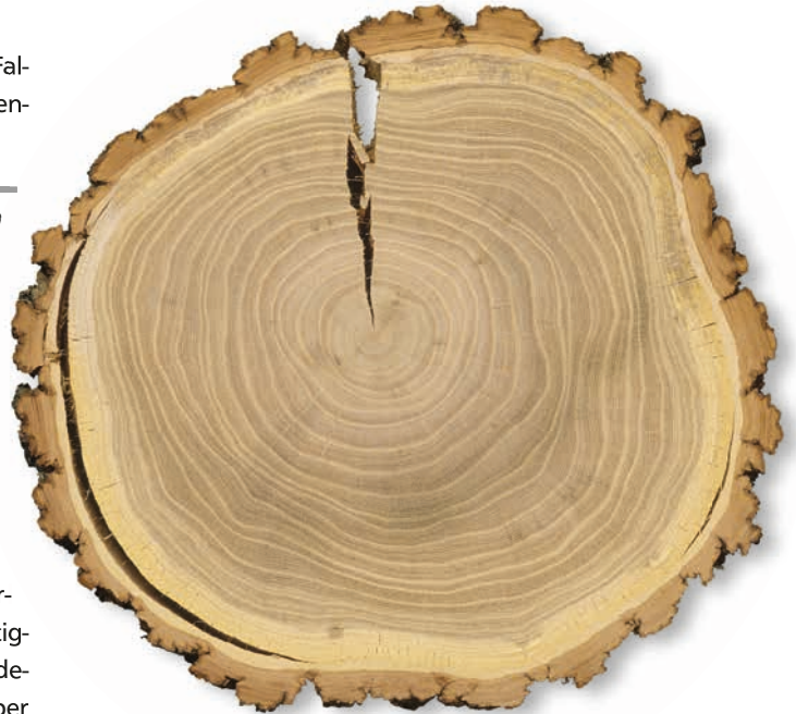
Abbildung 1: Stammscheibe einer Robinie mit 23 Jahresringen. Das helle, schmale Splintholz ist scharf vom dunklen Kernholz abgesetzt. Foto: Holzforschung München
