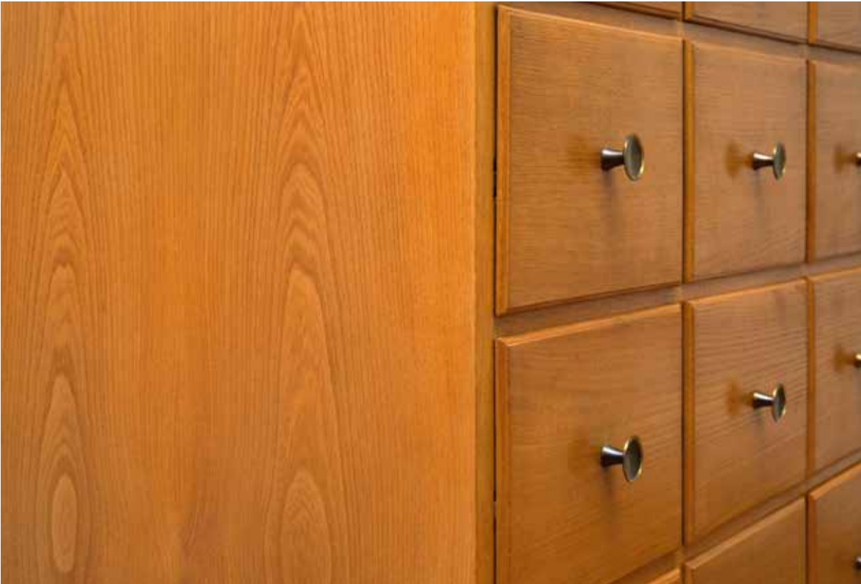
Abbildung 8: Detailaufnahme von Abbildung 12. Auf der Tangentialfläche tritt die charakteristische Doppelfladerung des Ulmenholzes deutlich hervor. Foto: Holzforschung München
