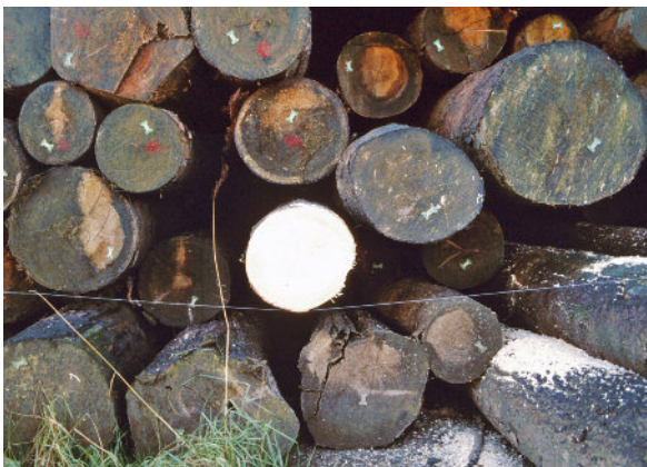
Abbildung 28: Bewachsene Stirnseiten und frischer Anschnitt Foto: LWF
