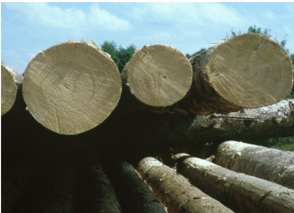
Abbildung 13: Detailansicht eines Polters. Lagerschäden wie Rotstreifigkeit und Bläue sind nicht vorhanden.
