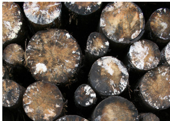
Abbildung 20: Wädhrend der Lagerung bildet sich auf den Stirnflächen ein Oberflächenmyzel.
