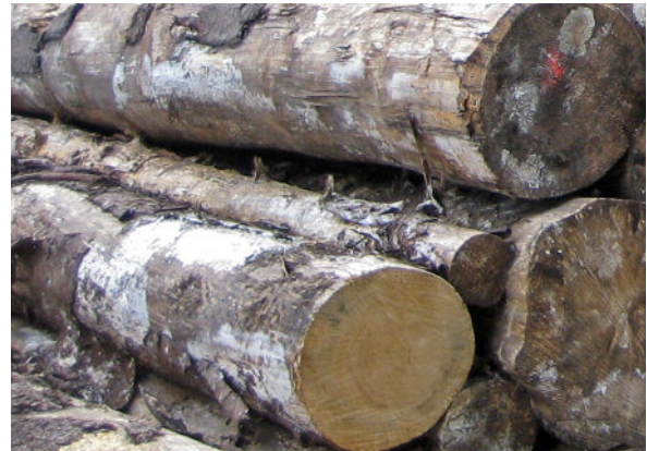
Abbildung 21: Trotz starker Verfärbungen ist der Anschnitt nach zehn Monaten Lagerdauer noch weiß.
