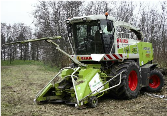
Abbildung 25: Der Holzerntevorsatz der Firma Biomasse Europa an einem Claas-Chassis für Umtriebszeiten bis etwa vier Jahre (Foto: F. Burger)
