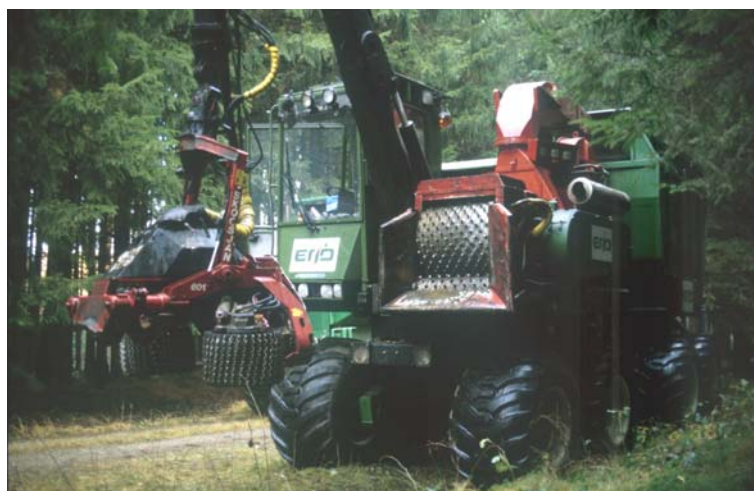
Abb. 2: Hackschnitzel-Harvester mit schwenkbarer Kabinen-Ausleger-Einheit
