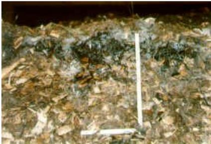
Abb. 33: Kondensationsband im Bereich der Schüttungskrone
