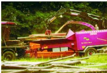
**Abb. 1: Mobiler Hacker JENZ HEM 30 D im Versuchseinsatz (" Würzburg")**
