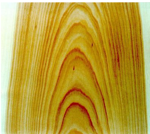
Abb.: 10 Furnier der Vogelbeere, kalt gemessert. Splint- und Kernholz sind farblich deutlich voneinander abgesetzt. Das Kernholz mit dem für Vogelbeere typischen Brauntönen [Foto: D. Grosser]
