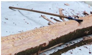
Abb. 5: Manuelle Entrindung eines Fichtenstammes auf Folienunterlage.
