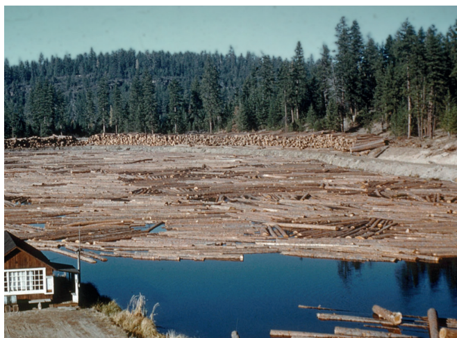
Wasserlagerung in Teichen oder Seen kann bei großen Schadereignissen sinnvoll sein.
