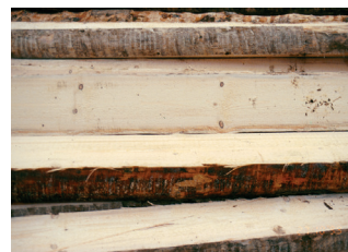
Geschnittene Bohlen guter Qualität aus entrindetem Holz aus Winterfällung nach mehrmonatiger Lagerung an der Waldstraße
