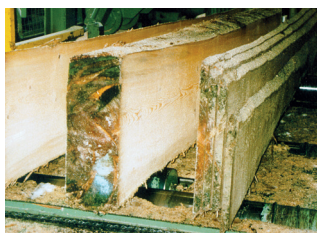
Über mehrere Jahre nassgelagerter Fichtenstamm nach dem Einschnitt
