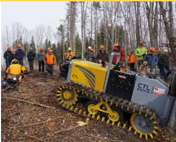
3 Einsatz funkgesteuerter Vorrückeraupen in Hanglagen und bei erweiterten Gassenabständen. Planung und Vorführung in Zusammenarbeit mit der WBV Landsberg und der Firma HSM.
