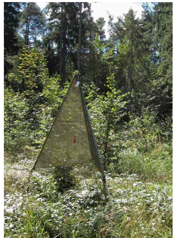
Mit solchen Netzpyramiden wird untersucht, wie mit neuen Ausbringungsverfahren Pflanzenschutzmittel abdriftfrei eingesetzt werden können. Eine der vielen Aufgaben der Waldschutz-Abteilung der LWF. Foto: R. Petercord, LWF
