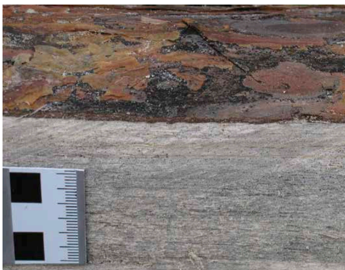
4 Sporenlager von Sphaeropsis sapinea auf der Rinde und umfangreiche Bläue im darunterliegenden Holz
