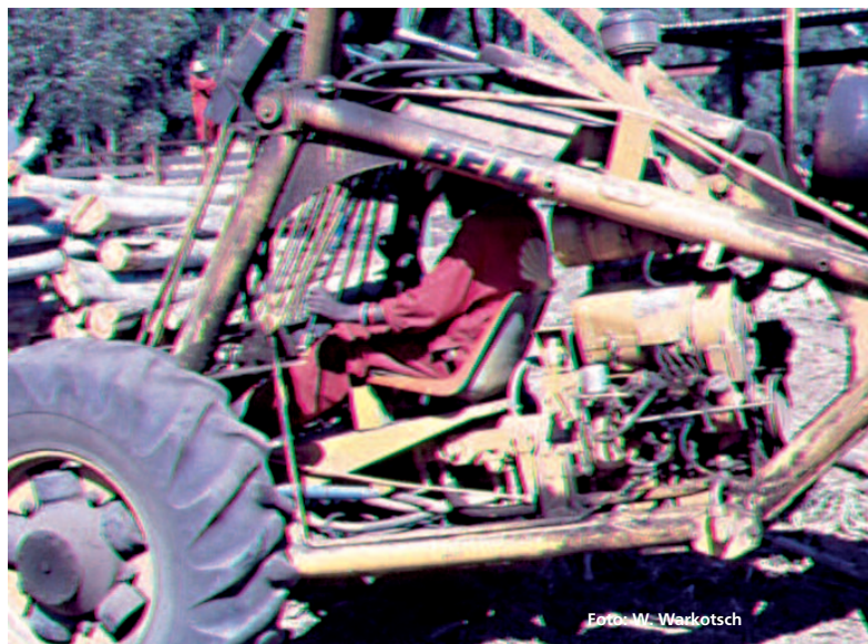
Abbildung 3: Ein Dreirad-Fahrzeugtyp für die Zuckerrohrernte, jedoch vollkommen unzulänglich adaptiert an die Verhältnisse in der Holzernte
