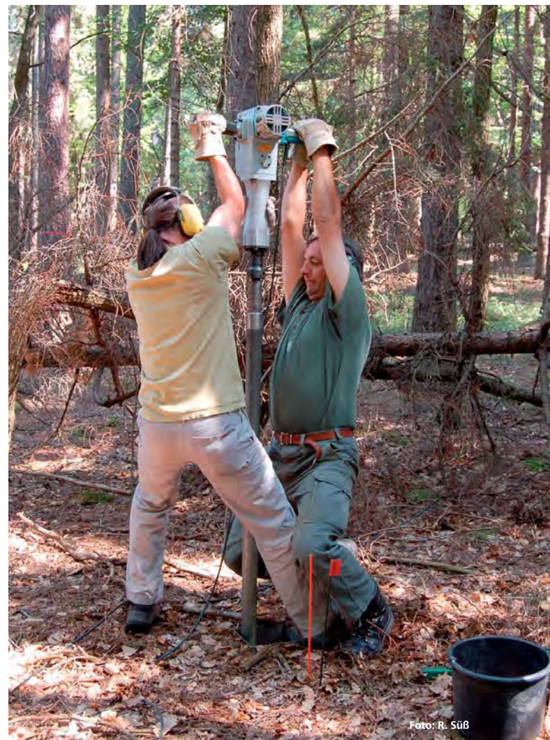
Abbildung 1: Mit der Rammkernsonde werden Bodenproben bis aus einer Tiefe von 150 cm gewonnen.
