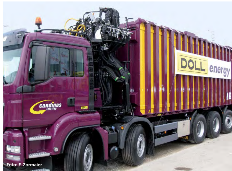
Abbildung 4: Werden Äste, Schwach- und Kronenholz nicht an der Waldstraße gehackt, könnte ein solcher Biomassetransporter (Prototyp) mit seiner Presskraft von 100 t das Material bis zu 50 Prozent verdichten und zu einer zentralen Hackeinrichtung transportieren.
