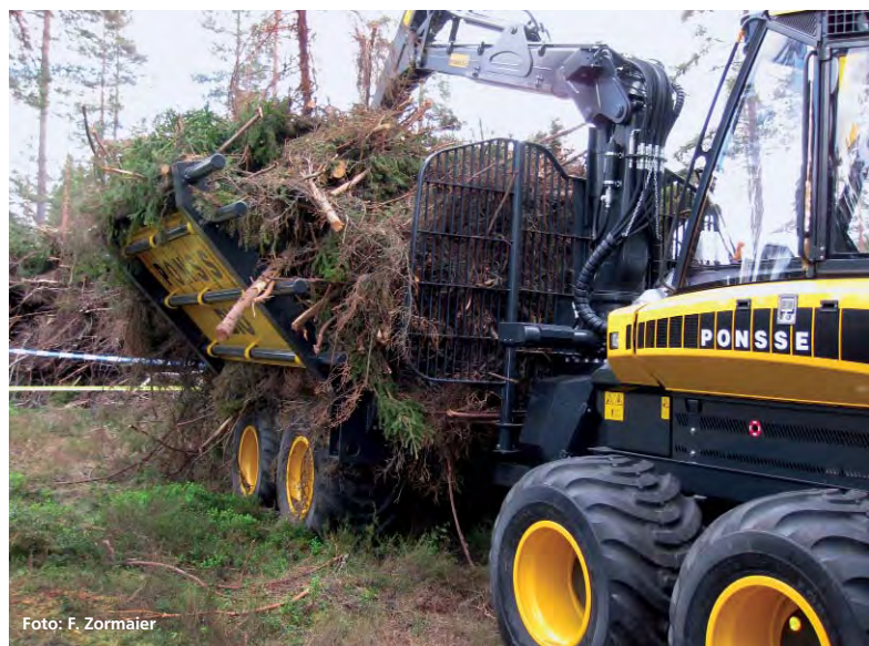
Abbildung 1: Mit einem Rückewagen wird Kronenmaterial aus dem Wald abtransportiert; eine besonders intensive Nutzungsform, die durchaus nicht jeder Standort verträgt.
