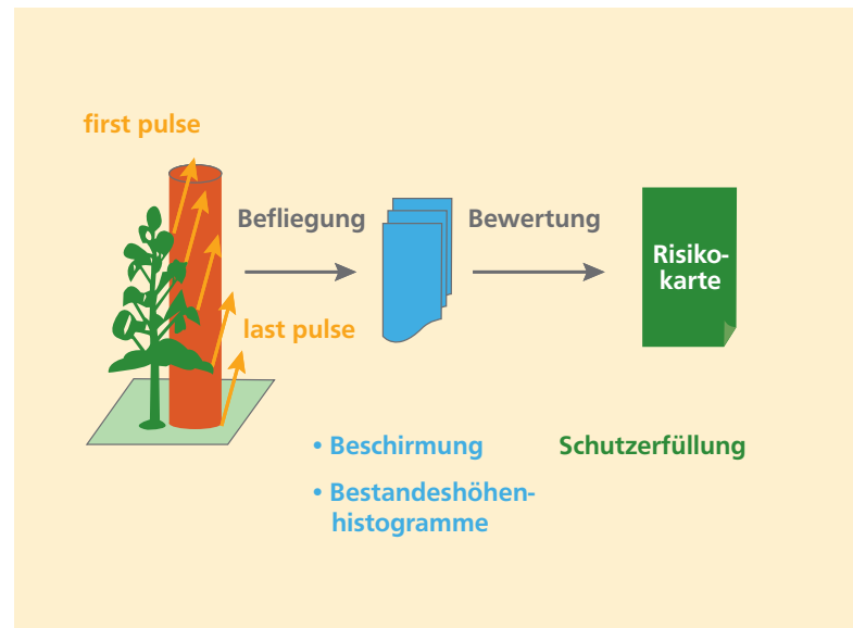
Abbildung 4: Schematischer Ablauf einer Laserscanner-Auswertung von Schutzwaldbeständen
