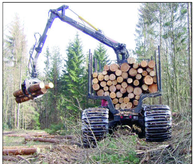
Abb. 1: Rückezug Valmet 840 mit aufgezogenen Bogiebändern zum Schutz eines Nassboden-Standorts (Foto: Forsttechnik BaySF )
