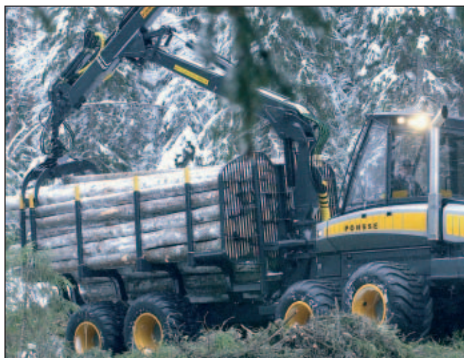
Abb. 2: Ponsse Buffalo DUAL: In nur 15 Minuten wird aus dem Harvester ein Forwarder, dessen Kran über ein Schnellwechselsystem mit Greifer oder Harvesteraggregat ausgerüstet werden kann. (Foto: Gebr. Konrad GmbH, Österreich)
