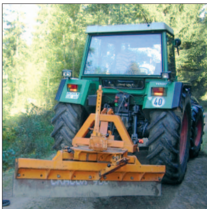
Abb. 1: Das R2005-Gerät ermöglicht eine einfache, aber sehr wirkungsvolle Pflege der Schotterwege. (Foto: Hölldorfer)
