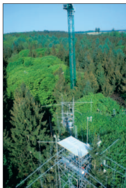
Abb. 2: Auf der Versuchsfläche der TU München im Kranzberger Forst steht ein großes Gerüst mit Kran, das den Forschern erlaubt, sich im und über dem Kronendach des Versuchsbestandes zu bewegen. (Foto: Archiv TU München)
