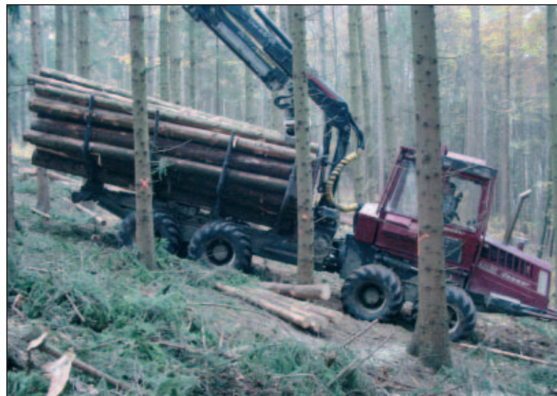
Abb. 1: Der eingesetzte Forwarder DASSER TRS 10.8 in der Hangvariante beim Bergauf-Rücken ohne Bogiebänder (Foto: J. Kremer)
