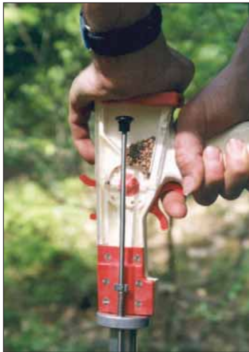
Abb. 5: Eine Transportscheibe nimmt eine bestimmte Anzahl Samenkörner mit. Meist fielen zwei bis drei Körner in den Kegel.
