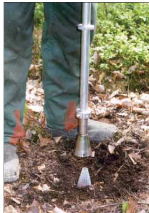
Abb. 6: Mit dem schwarzen Hebel neben dem Samendepot (Abb. 5) wird der Plastikkegel freigegeben.
