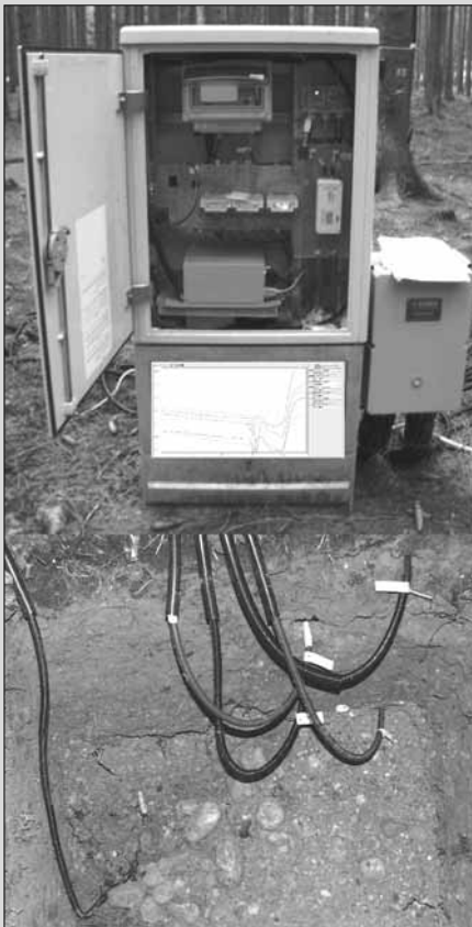
Abb. 5: Bodenfeuchte-Messeinrichtung an der Waldklimastation Ebersberg
