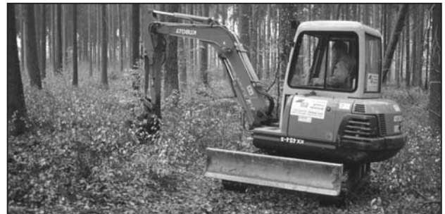
Abb. 1: Der eingesetzte 3,8 t-Bagger mit 5 m-Kran zur maschinellen Wildlingsgewinnung.
