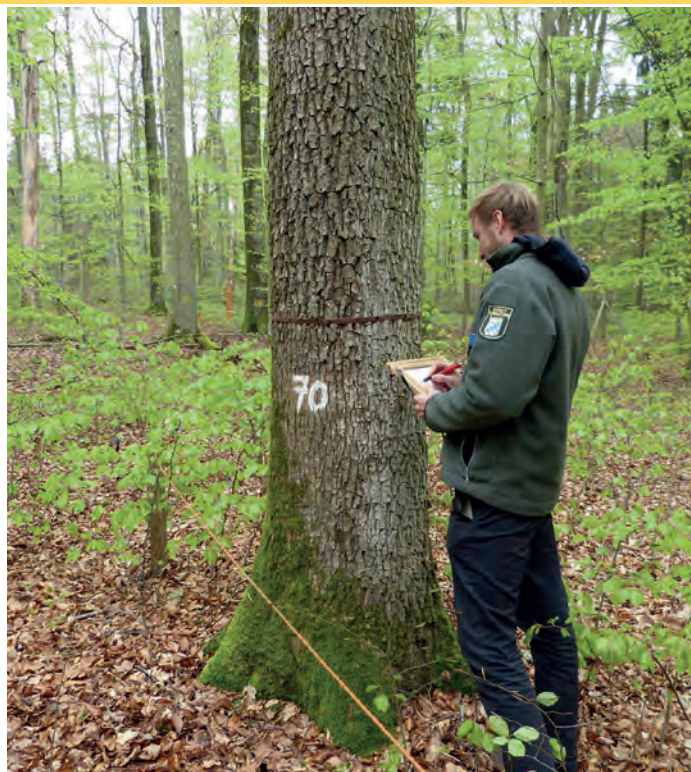
1 Ein Mitarbeiter der LWF liest die aktuellen Durchmesserwerte an den Permanent-Umfangmessbändern der Probestämme ab.
