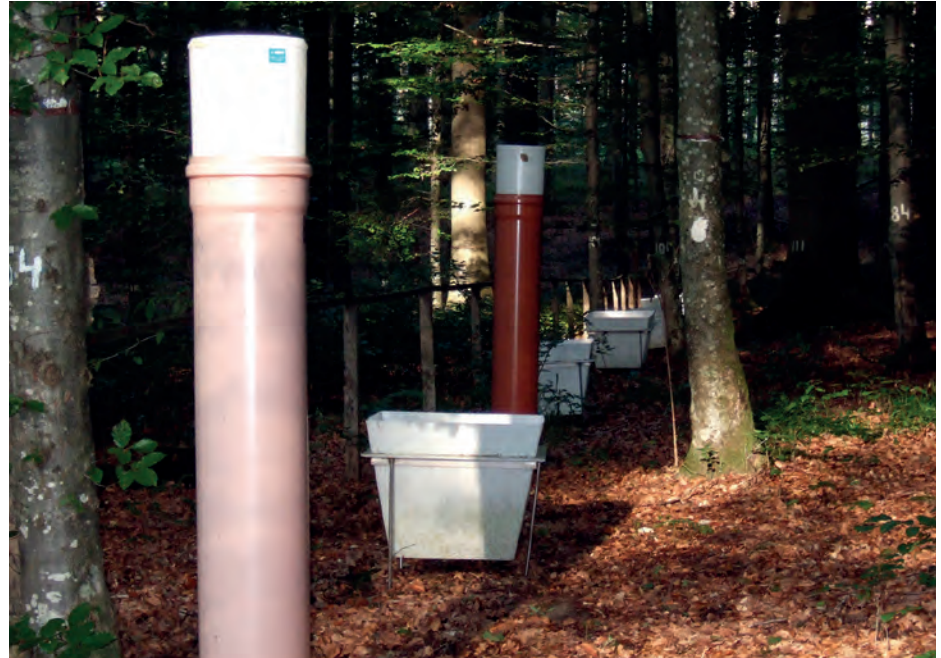
1 Stickstoff-Depositionssammler auf der WKS Freising Foto: S. Raspe, LWF
