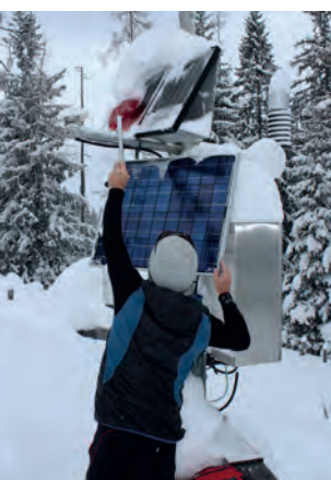
Die Reinigung der Solarpanels gehört genauso zu den Aufgaben eines WKS-Probennehmers wie der prüfende Blick in den Elektronikkasten. Fotos: D. Köhler, LWF
