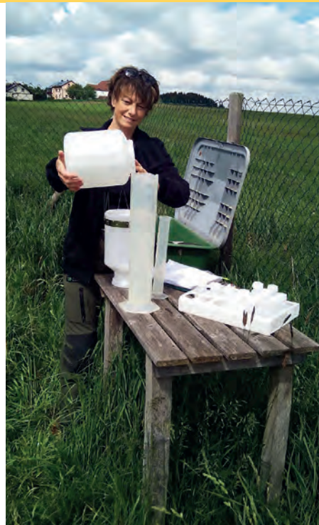
7 Auch auf den Freilandmessstellen der Waldklimastationen werden Stickstoff und andere Schadstoffe gemessen, die mit dem Niederschlag oder als Stäube in den Wald eingetragen werden. Die Probennehmerin der WKS Höglwald, Eva Rusch, leert einen Depositionssammler auf der Freilandmessstelle.
