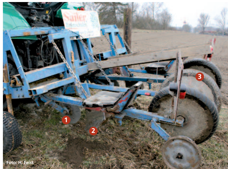
Abbildung 5: Pflanzmaschine: Metallscheibe zum Durchtrennen des Oberbodens (1), Pflug zum Öffnen der Pflanzrille (2), mit Beton ausgegossene Reifen zum Verschließen der Pflanzrille (3)
