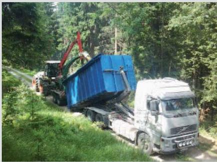
Sie können in einer Stunde bis zu 180 Raummeter Hackschnitzel produzieren. Wenn mobile Großhacker diese Leistung aber auch abrufen sollen, dann müssen alle Zähne im »Getriebe der Hackschnitzelbereitstellung« reibungslos ineinandergreifen.
