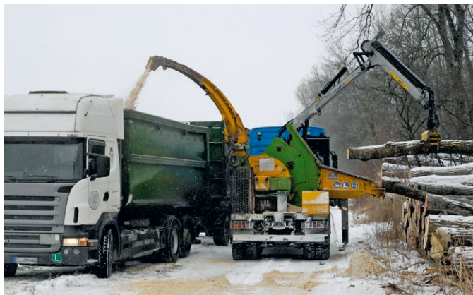
Maschinenaufstellung bei ausreichender Wegebreite
