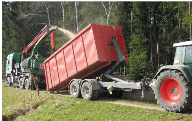
Maschinenaufstellung bei geringer Wegebreite
