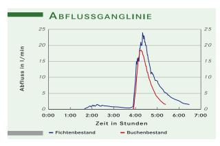
Abbildung 43: Abflussganglinie eines Fichten- und eines Buchenreinbestandes (Nordmann 2007, unveröffentlicht); 0:00 Beginn der ersten Beregnung (1 Stunde à 50 mm), 2 Stunden Wartezeit, 3:00 Beginn der zweiten Beregnung (1 Stunde à 50 mm), Rest: auslaufende Zeit
