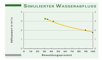
Abbildung 41: Simulierter mittlerer Hochwasserabfluss (m³/s) für das Untersuchungsgebiet Geltendorf
