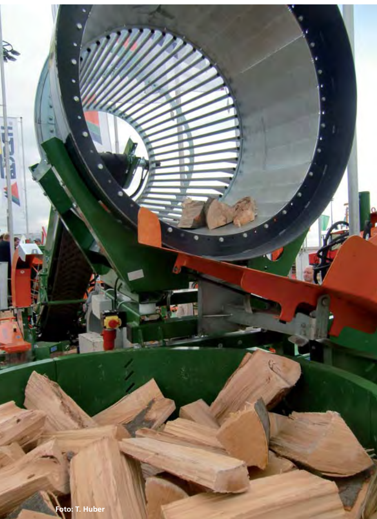
Abbildung 3: Manche Sägespaltautomaten können bis zu 80 Zentimeter starke Stämme zu Scheitholz zerlegen. Eine Sieb-Trommel sortgt anschließend für »sauberes« und staubfreies Scheitholz.
