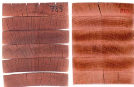
Abbildung 3: Prüfkörper nach der Delaminierungsprüfung; links: Fugen wurden bereits kurz nach dem Leimauftrag verpresst; rechts: Die Fugen wurden erst nach längerer Wartezeit verpresst.
