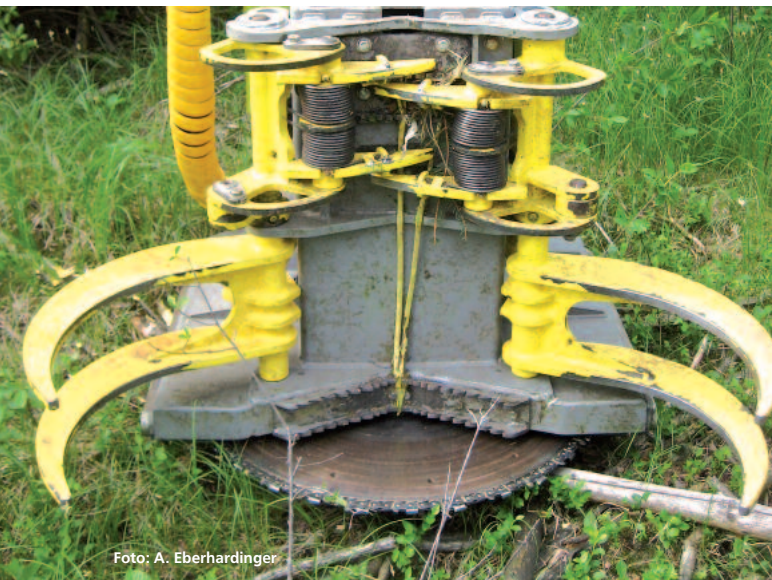
Abbildung 2: Das Sammelaggregat Bracke C16.a ist mit einer auf eine Stahlscheibe montierten Sägekette ausgestattet.
