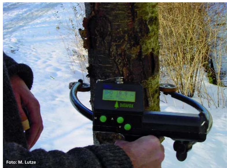
Abbildung 1: Mit Hilfe elektronischer Geräte wie z. B. einer elektronischen Einhandkluppe werden die Daten einfach und problemlos erhoben und können schnell und zuverlässig vom Programm HOLZERnte 7.1 weiterverarbeitet werden.
