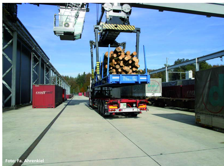
Abbildung 1: Das Wechselaufbau-System HolzWab wurde für den LKW- und Bahnverkehr entwickelt. Ein LKW kann fünf leere HolzWabs gleichzeitig in den Wald transportieren und dort abstellen. In einen HolzWab passen bis zu 27 Tonnen Rundholz.
