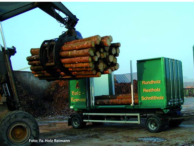
Abbildung 2: Kraemer Containeraufbau für flexiblen Transport von Rundholz und Schüttgütern
