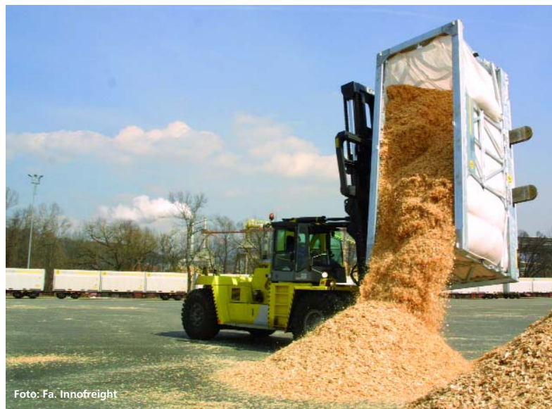
Abbildung 3: »Innofold F20«; der Schüttgut-Behälter ist schnell zusammengeklappt. Somit lassen sich zwei Drittel des Transportraums beim Hin- oder Rücktransport anderweitig nutzen.
