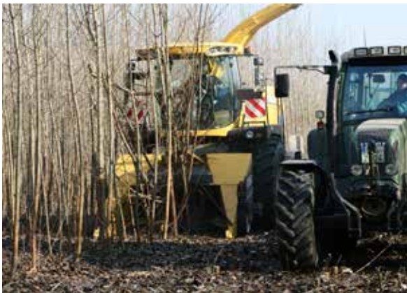
Abbildung 2: New Holland Gehölmähhäcksler Typ FR 9060 mit Vorsatz 130 FB Foto: F. Burger
