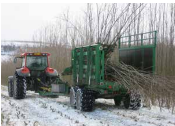
Abbildung 3: Mähemmer Stemster MK III bei der Ernte Foto: J. Schweiher
