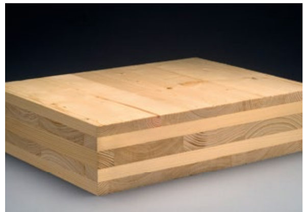
Abbildung 12: Brettsperrholz Foto: Holzforschung München
