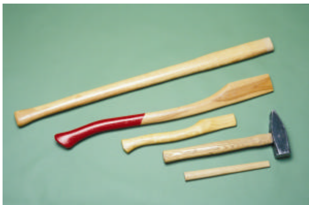
Abb. 2: Werkzeugstiele aus Esche
