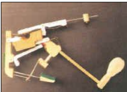
Abb. 1: Eins der 88 Glieder einer Piano-(Klavier-)mechanik
