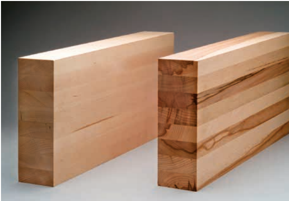
Abbildung 2a: Brettschichtholz ohne und mit Rotkern.
