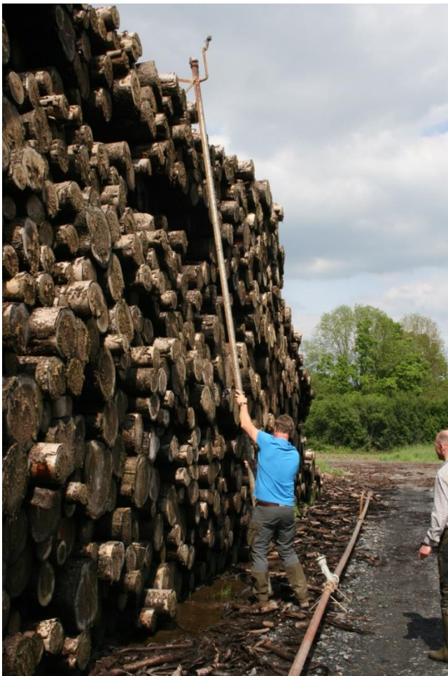
Abbildung 17: Senkrecht gestellte Segmentregner übernehmen die Befeuchtung der straßenabgewandten Stirnflächen bei Boxen mit zwei Strängen.
