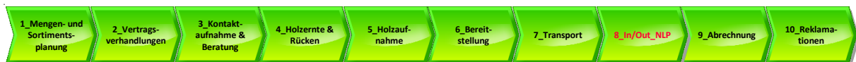
Abbildung 18: Geschäftsprozess „Holzbereitstellung und Vermarktung“ mit dem rotgezeichneten Teilprozess „In/Out NLP“, der die zusätzlichen Verfahrensschritte beim Integrieren eines Nasslagermanagements in bestehende Unternehmensabläufe symbolisiert, nach LUTZE 2016.
