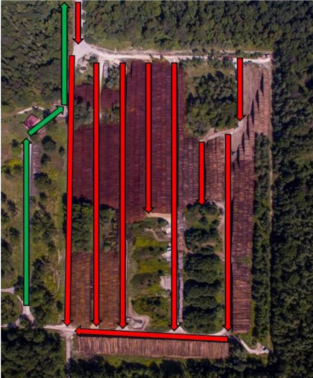
Abbildung 10: Wegenetz eines größeren Nasslagerplatzes mit Ringverkehr (Quelle, Bay. Staatsforsten 2019).
