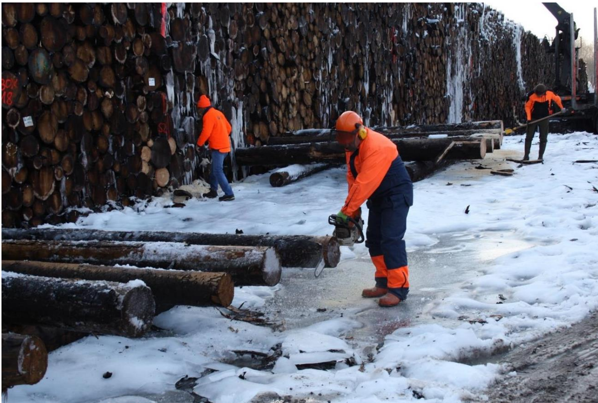
Abbildung 20: Güteansprache und Festlegung über Sektionsverfahren im Nasslager (Quelle, Bay. Staatsforsten 2019).
