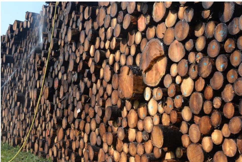
Abbildung 22: Holz im „Regenschatten“ oder ungenügend positionierte Segmentregner bedingen Holzentwertungen.
