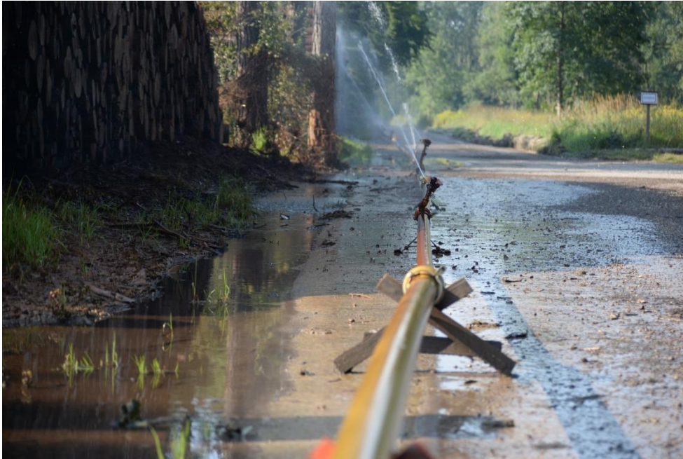
Abbildung 16: Basisberegnung entlang der Polterstirnseiten.
