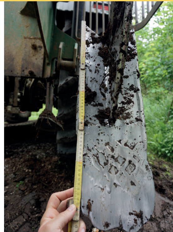
6 Die bis zu 20 cm breiten Spaten sind zwischen 60 und 90 cm lang und brechen den Boden bis zu einem halben Meter auf. Foto: S. Waas, LWF
