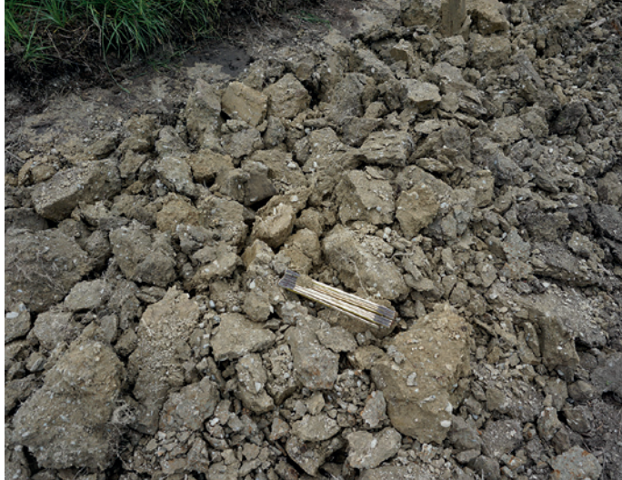
5 Gelockerte Rückegasse mit grob aufgetroffenen Bodenklumpen im Durchmesser von 10 bis 20 cm Foto: S. Waas, LWF
