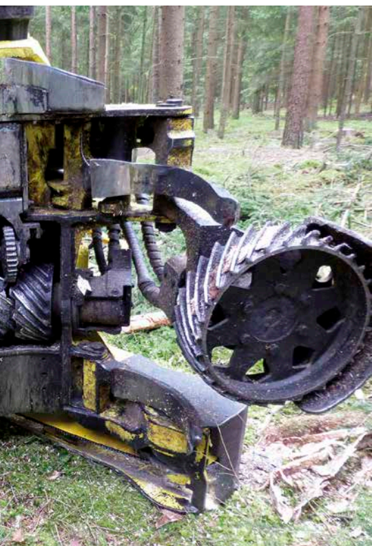
3 Entrindender Harvesterkopf mit speziell für diesen Zweck geformten Vorschubwalzen Foto: F. Schulmeyer
