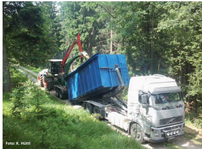
Abbildung 4: Beim Hacken im Wald werden häufig Container-LKW zum Transport der Hackschnitzel eingesetzt.
