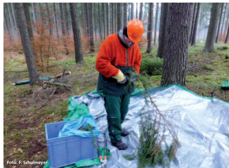
Abbildung 2: Aufarbeitung eines Probenastes. Feinreisig und Nadeln werden vom Ast getrennt verpackt und zur Analyse ins Labor gebracht.
