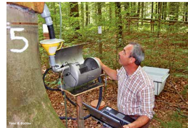
Ein Mitarbeiter der LWF überprüft die Messeinrichtung für den Stammablauf.
