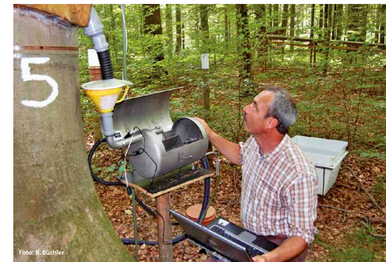
Ein Mitarbeiter der LWF überprüft die Messeinrichtung für den Stammblauf.
